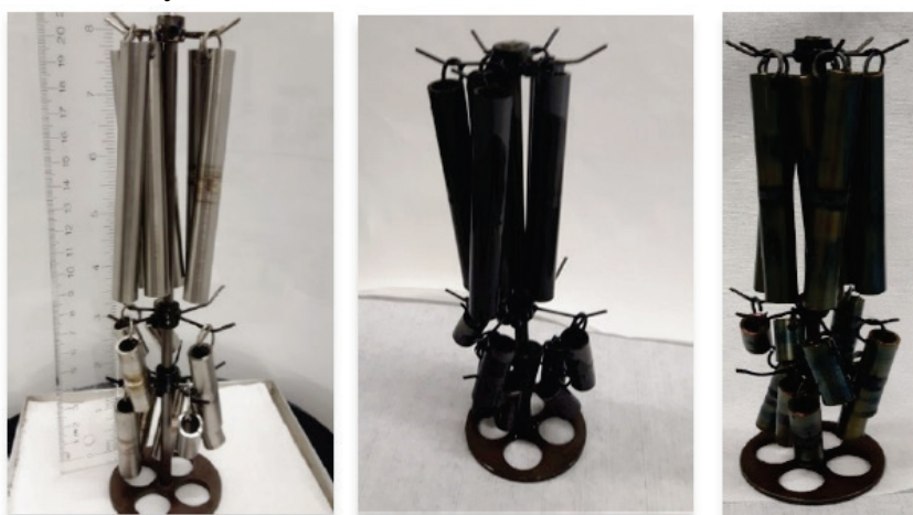
図 SCWR 8. 腐食試験前（左）、250 時間の曝露後の 800H（中央） および 500 時間の曝露後の Alloy 625（右）
