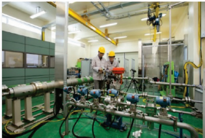
図 VHTR 6. 硫酸分解および SiC 被覆プロセス熱交換器を含む研究に使用される小規模窒素ガスループ
