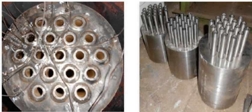
図 LFR4. 菅板に熱交換管を取り付けるアセンブリの試験
