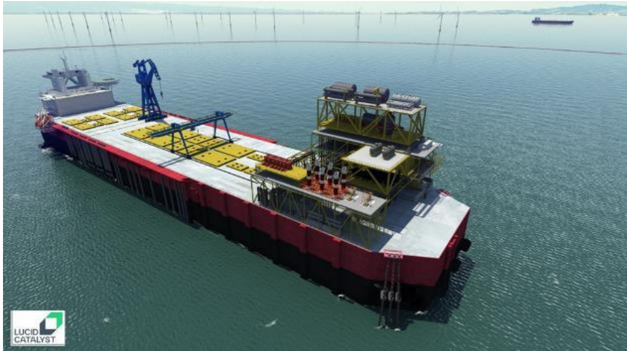
図34.水素、アンモニアの製造及び脱塩を行う施設を備えた浮体式生産貯蔵施設
